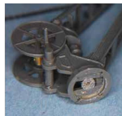
4 Pour fixer un axe sous la grue, il faut percer.
