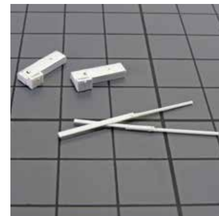
15 Collez le bas du levier sur un profilé EVG 102. Fixez les rivets avec de la colle fluide (MEK par exemple).
