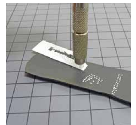
14 Préparez les rivets (diamètre 0,4 mm, en carte plastique de 0,25 mm) qui seront posés sur le manche et sur le support de levier.
