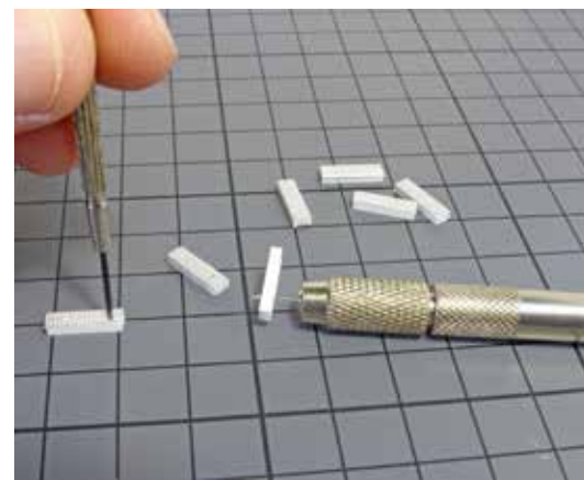
8 Collez l'aluminium sur le boîtier. Ajustez les bords, puis reprenez les perçages avec un tournevis (trou ovale) et un foret (trou rond).
