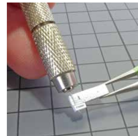
12 Avec un foret de 0,4 mm, percez le support de levier, de manière séparée (un côté après l'autre).
