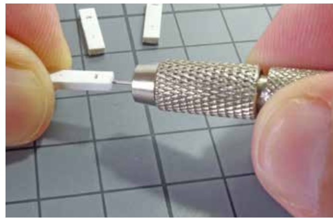
6 Avec un foret de 0,5 mm, percez les extrémités du socle du boîtier. Essayez de rester bien au milieu.
