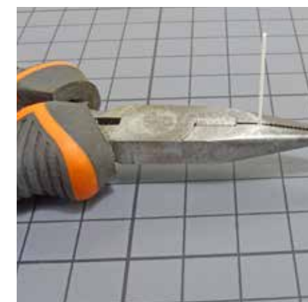
13 Coupez un profilé EVG 218 (L : 30 mm). Avec une pince plate, écrasez l'extrémité sur environ 10 mm. Ces dimensions seront ajustées plus tard.
