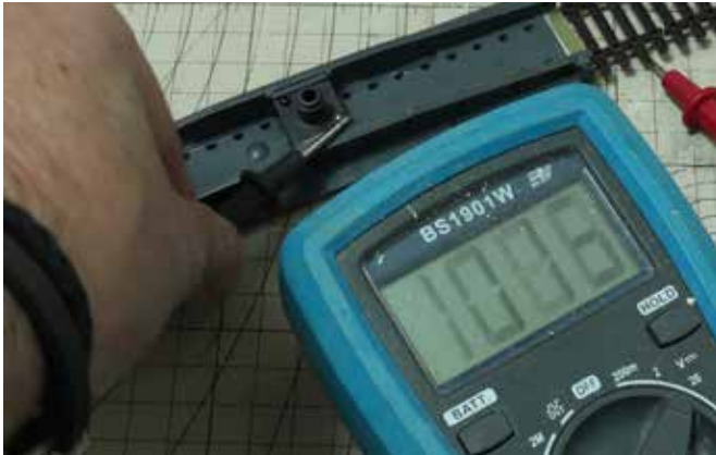
17 L'opération terminée, il faut nettoyer soigneusement (essence F) les résidus de flux, et vérifier la connexion électrique entre le rail et la partie inférieure du contacteur avant qu'il ne soit trop tard !
