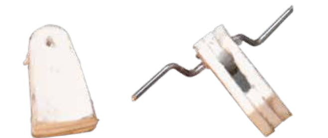
34 Pour terminer le détaillage, il ne manque plus que les treuils de commande. L'armature est en carte plastique de 1 mm d'épaisseur. La manivelle est en corde à piano de 0,5 mm de diamètre.
