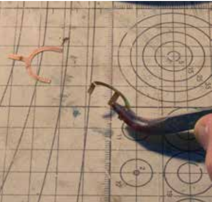
24 À ce stade, je peux placer les lames de contact semi-circulaires au centre de la fosse. Ces dernières sont mises en forme à la pince plate pour créer les pattes qui traverseront la fosse dans les fentes prévues à cet effet.
