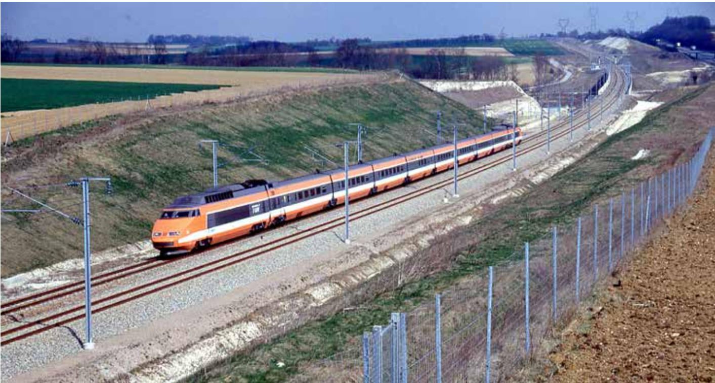
6500 m de rayon, pour une courbe de ligne à grande vitesse, c'est courant. Cela fait environ 75 m en H0 ! Il va falloir transposer (LGV Sud-Est en 1993).
