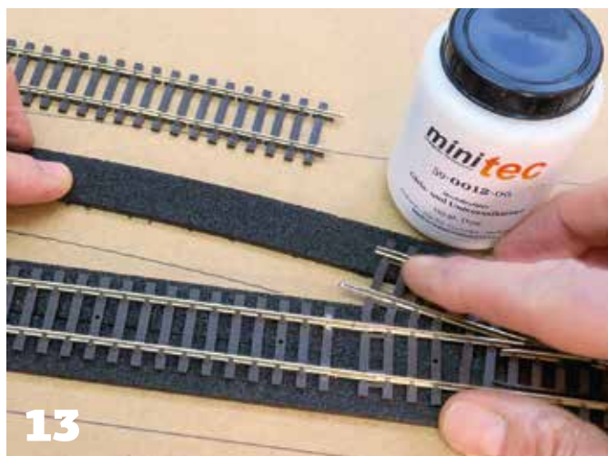
13 Il est temps de disposer la semelle de ballast. Ici, une semelle Minitec.
