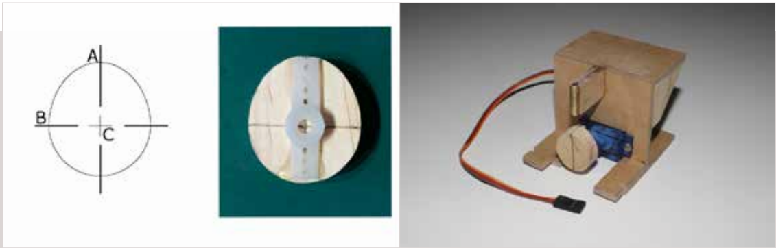
Figure 6-2 la came (à gauche) et le support du servomoteur (à droite)
